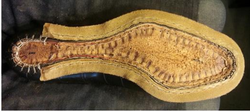
Şekil 3.15 Vardolası (Şerit) Patuma Dikişi İle Tutturulmuş Yarı Mamül Ayakkabı (Yardımcı Malzemeler; Taban Astarı, Vardola ve İp). (Kastan, 2022, s. 26).
