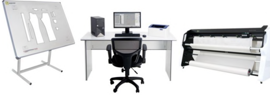
Şekil 3.12 Dijit Masası, Bilgisayar Sistemi ve Çizici (Astaş Juki, t.y.)
