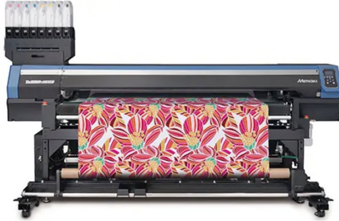
Şekil 3.9 Kumaşa Direk Baskı Yapabilen Dijital Baskı Makinesi (Mimaki, t.y.)
